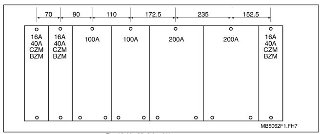
Fig. 12-16: Module widths
