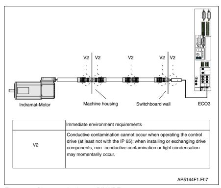
Fig. 15-2: Dirt contamination per DIN VDE 0160
