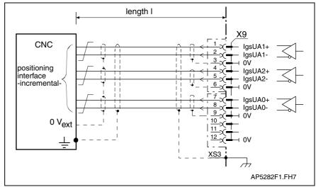
Fig. 4-125: Connection of incremental actual position value output
